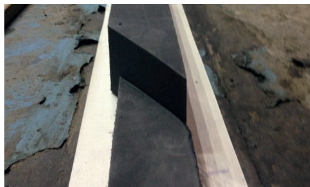
Contacto seguro de los perfiles con corte angular de 60°
